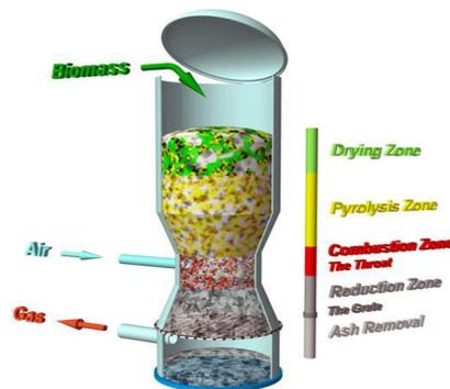
Figura 5: Reattore a carica "Batch" (Upsala University)
